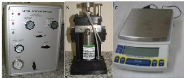
Figura 3: (A) UltraPoroPerm 500, (B) Copo matriz e (C) Balança semi-analítica.
