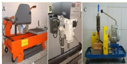
Figura 2: (A) Serra, (B) Plugadeira manual e (C) Retificadora.
