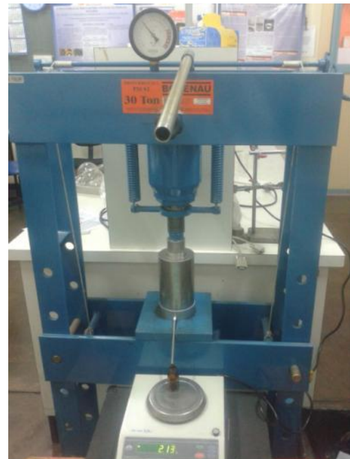
Figura 3 – Prensa utilizada na extração de óleo da semente de moringa.
