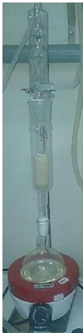
Figura 2 – Aparelho de Soxhlet utilizado na extração de óleo da semente de moringa.
