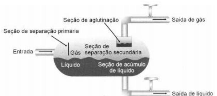
Figura 1: Esquema de um separador bifásico (Fonte: THOMAS [2004])
