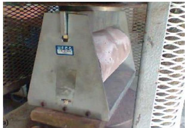
Figura 3: Ensaio de tração por compressão diametral.
