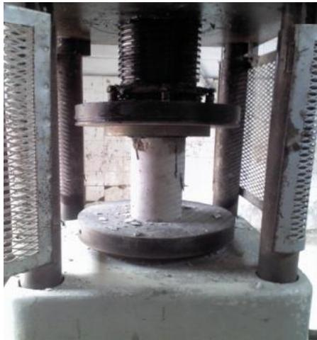
Figura 1: Ensaio de resistência à compressão.
