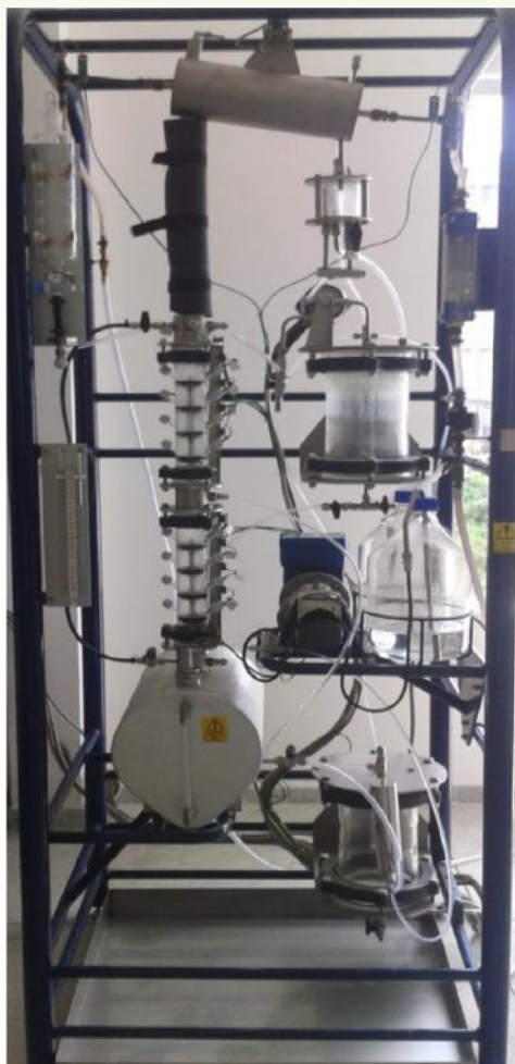
Figura 1: Planta de destilação de modelo UOP3CC suportada em uma estrutura de aço tubular.
