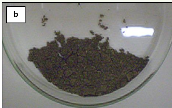
Figura 01 – a) aspecto da amostra AM1 antes da extração Soxhlet e b) amostra já extraída e pulverizada.
