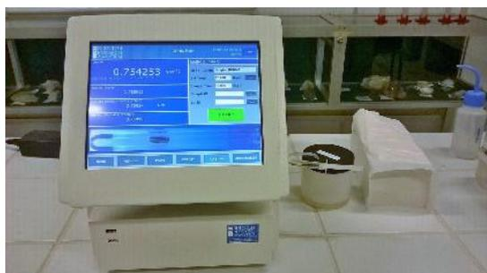
Figura 2 – Resultado do ensaio de massa específica de amostra de gasolina tipo C coletada no Município de Patu-RN.
