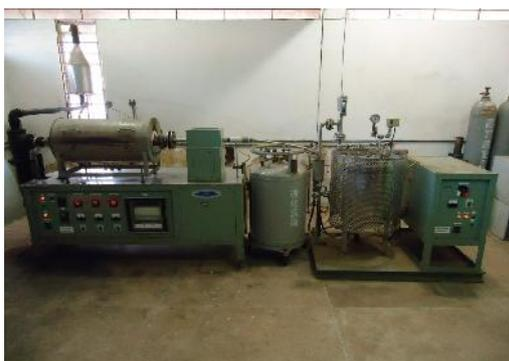
Figura 1: Foto do forno-reator tubular de leito fixo com rampa de aquecimento digital em atmosfera de  $N_2$  para pirólise da CHINO, adaptado à caldeira.
