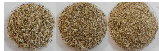
Figura 3.2 – Meio filtrante casca da moringa, diâmetros: 1,70mm (a), 1,19mm (b) e 0,84mm (c).
