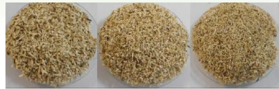
Figura 3.1 – Meio filtrante vagem da moringa, diâmetros: 1,70mm (a), 1,19mm (b) e 0,84mm (c).
