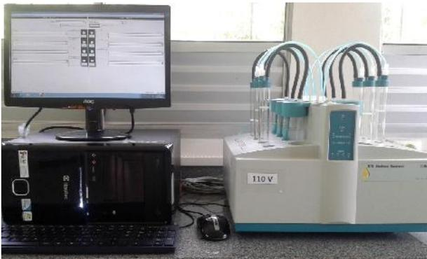
Figura 2: Equipamento Rancimat utilizado para medir a estabilidade à oxidação.
