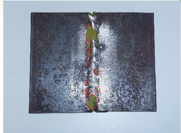
Figura 3: Corpo de prova com o acúmulo de Partículas Magnéticas nas falhas.
