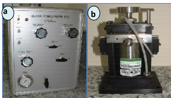
Figura 7: (a) UltraPoroPerm 500, (b) Copo matriz.
