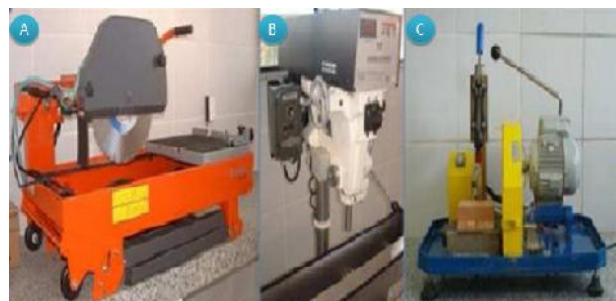
Figura 5: (a) Serra, (b) Plugadeira manual e (c) Retificadora.
