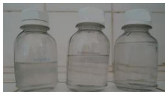
Figura 5- Vinhaça clarificada tratada com 5g/L, 10g/L e 15g/L de  $Al_2(SO_4)_3$ , após adsorção com carvão ativado.
