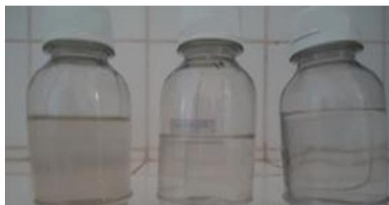
Figura 7 - Vinhaça clarificada tratada com 5g/L, 10g/L e 15g/L de  $\text{FeCl}_3$ , após adsorção com carvão ativado.
