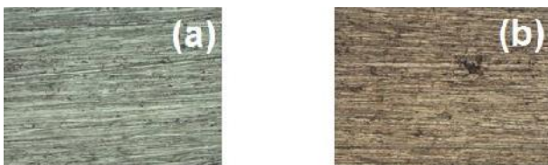
Figura 4 – Aspecto das lâminas de cobre, por microscopia (a) Antes, (b) Depois, do ensaio
