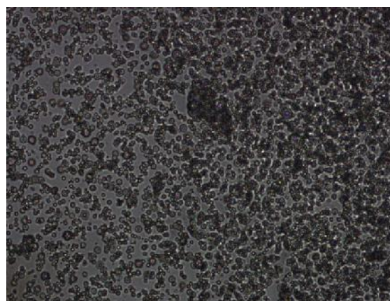
Figura 3: Imagens obtidas pela microscopia para todos os teores de água (10%, 20%, 30%, 40% e 50% respectivamente) a uma temperatura de 25°C (±2°C) com uma magnificação de 200 vezes (x200).
