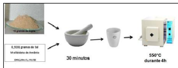
Figura 4: Esquema de impregnação da bentonita com MoO_3 .
