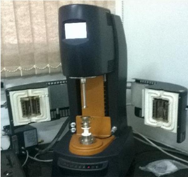
Fig. 3 Reômetro placa/placa testes iniciais.
