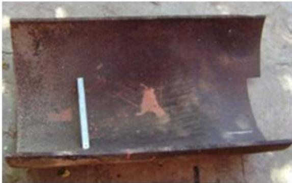
Figura 3: Pedaço da tubulação de aço API 5L X60 utilizado no trabalho.
