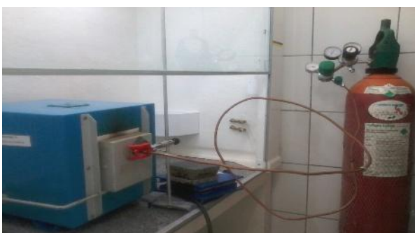
Figura 1: Sistema de Torrefação
