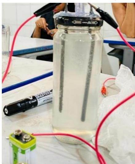
Essa corrente gerada pelas pilhas de nove volts chegava até o interior de um recipiente hermético, através dos eletrodos de solda e, assim ocorria a reação de quebra da molécula de água, ou seja, a incidência de energia elétrica estava forçando a ocorrência de uma reação química não espontânea a 25° C e 1 atm de pressão.
