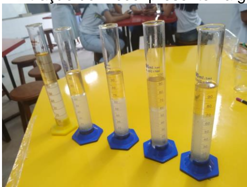
Imagem 01. Extração do Álcool presente na gasolina (Teste da Proveta)
