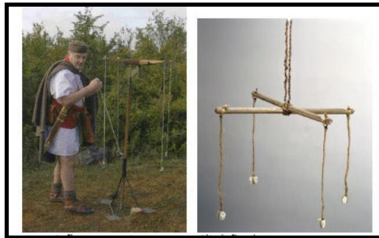
Figura 20 – Reconstituição de uma Groma
