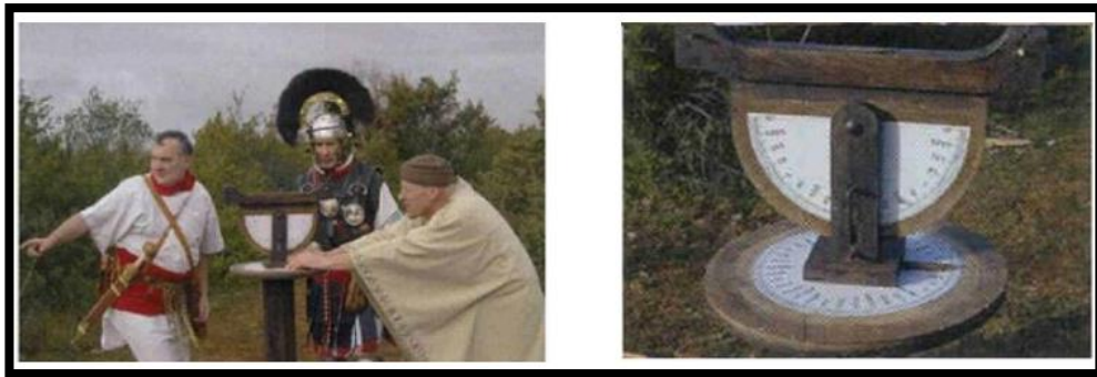
Figura 21 – Reconstituição do uso da Dioptra – Disco vertical hgraduado em 90°
