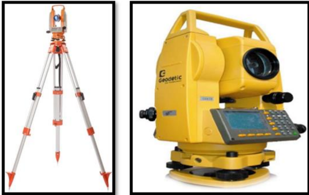
Figura 23 – Teodolito de luneta (esquerda) e teodolito eletrônico (direita)
