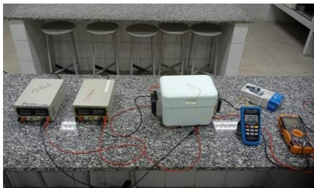
Figura 6. Esquema experimental de uma mini geladeira
