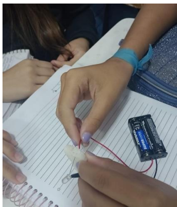
Figura 4 – Teste de condutividade elétrica com pedra de jardim
