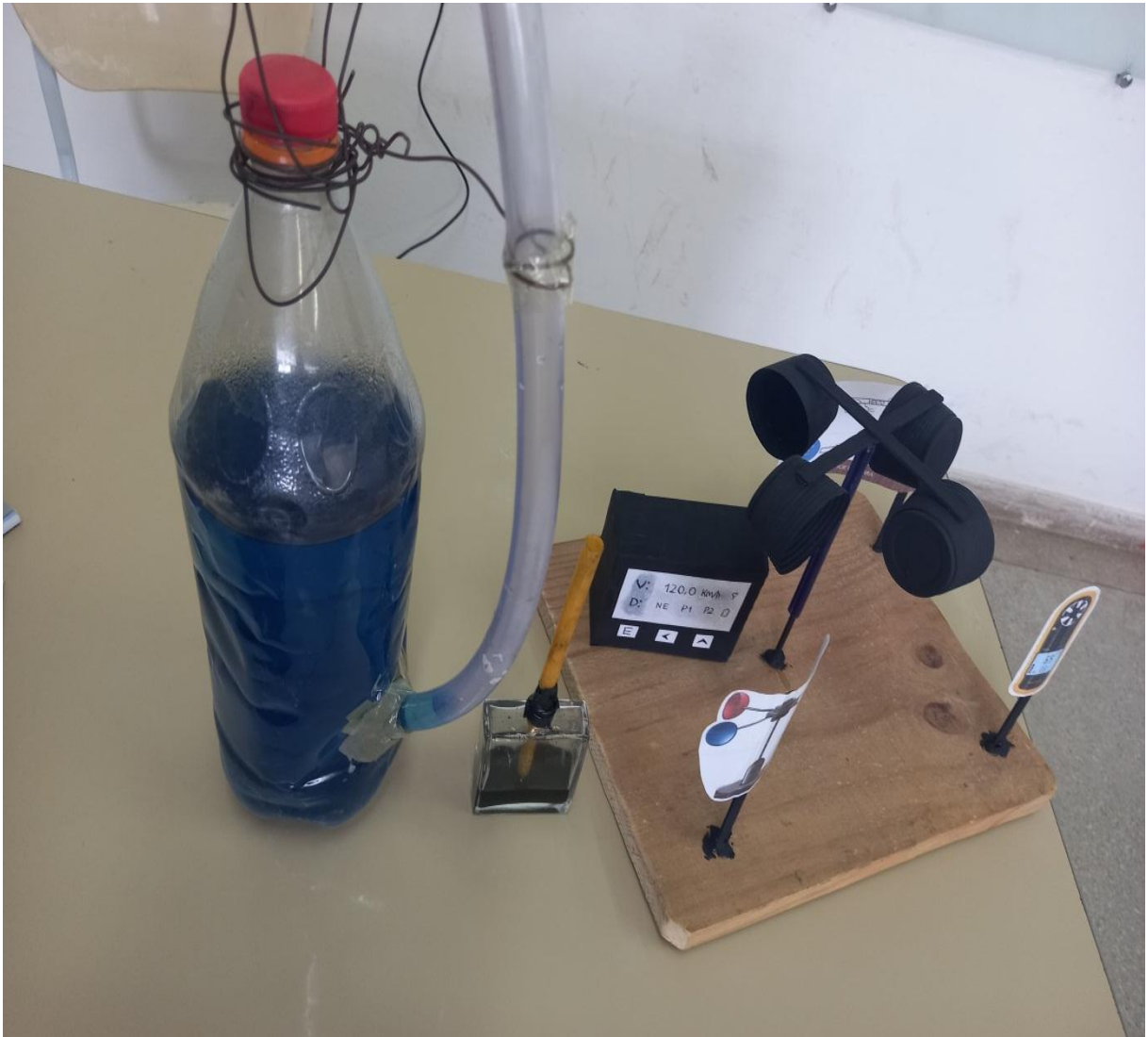
Figura 1- Recursos elaborados pela turma de climatologia, termômetro, pluviômetro, e anemômetro.
