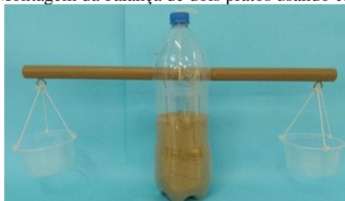
Figura 4: Montagem da balança de dois pratos usando cano de PVC
