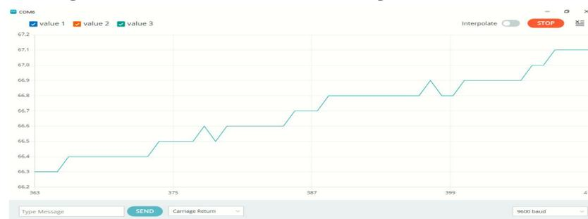
Depois destes processos, foi definido o código e realizadas as medições diretas. O sensor foi alocado ao rotor, em contato direto com a camada interna do rotor bobinado, junto a isso, foi medido a tensão da corrente com um alicate amperímetro e feito o acompanhamento da variação térmica. Com cerca de uma hora de ensaio, pôde-se perceber um início de estabilidade na temperatura.
