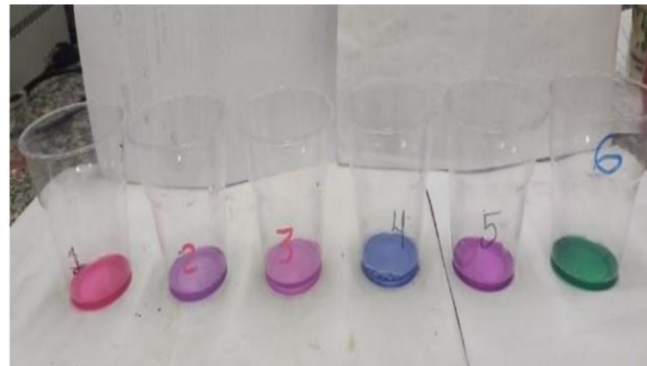
Figura 4: Escala de padrões de pH, construídas através do extrato do repolho roxo.
