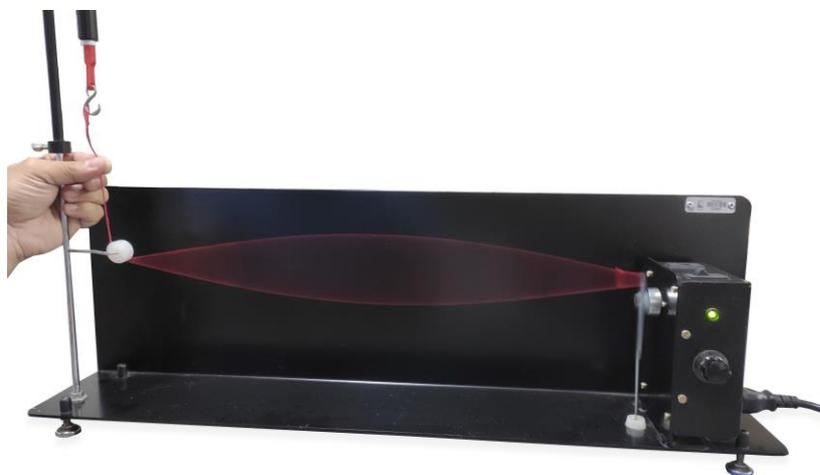
**Figura 8** – 1<sup>o</sup> Harmônico obtido experimentalmente.
