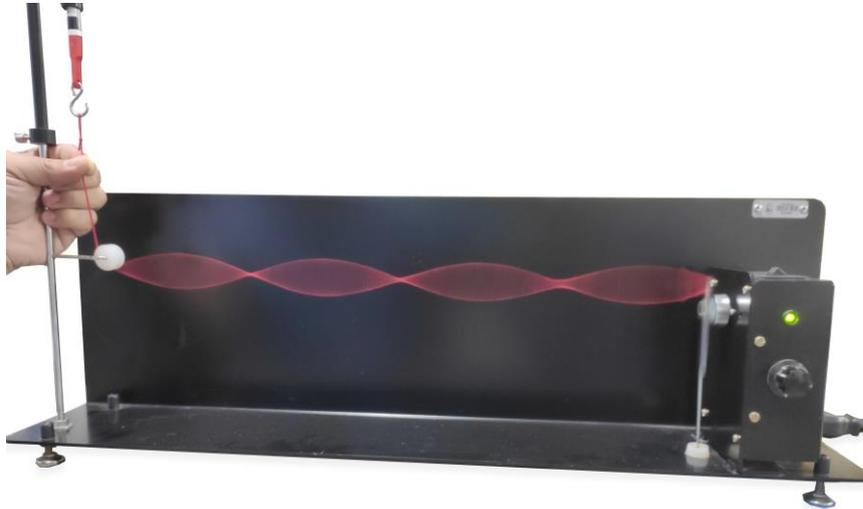
**Figura 11** – 4º Harmônico obtido experimentalmente.
