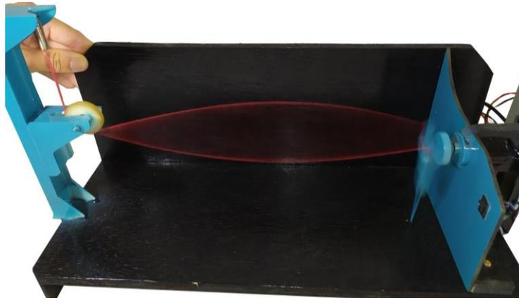
**Figura 4** – 1º Harmônico obtido experimentalmente.
