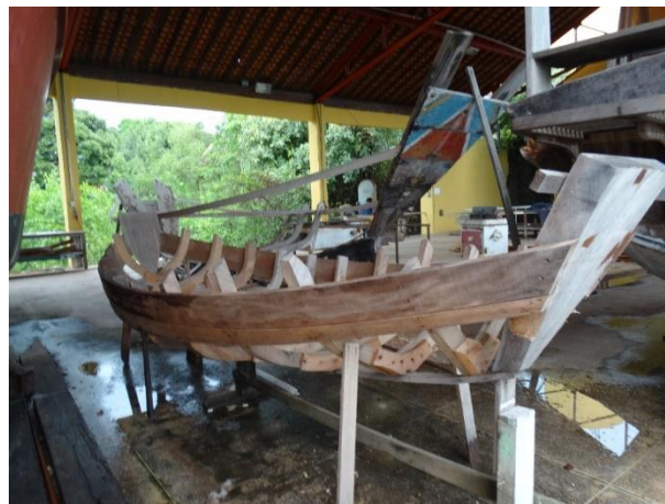
Figura 2: Estrutura inicial de uma embarcação. Pode-se observar a proa, popa, quilha e cavernas.
