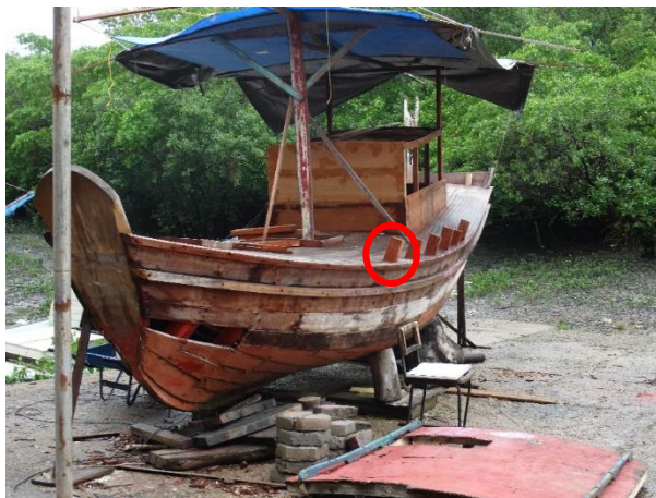
Figura 1: Biana com casario na qual o mestre estava trabalhando. Em destaque, é possível visualizar uma das cabeças já colocadas na embarcação.
