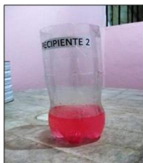
Figura 4. Recipiente 2, volume 2L, com volume deslocado do recipiente 1 após a imersão do corpo de 350 mL.
