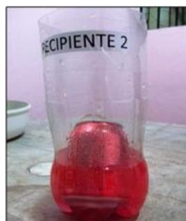
Figura 5. Recipiente 2 com corpo de 350 mL imerso no volume de água deslocado no recipiente 1.
