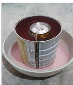
Figura 3. Recipiente 1 com corpo de 350 mL imerso na água e volume deslocado no recipiente aparador.
