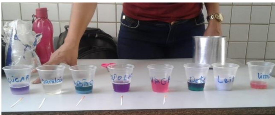
Figura 2: Observação dos solventes com a utilização dos extratos de repolho roxo e casca da uva.
