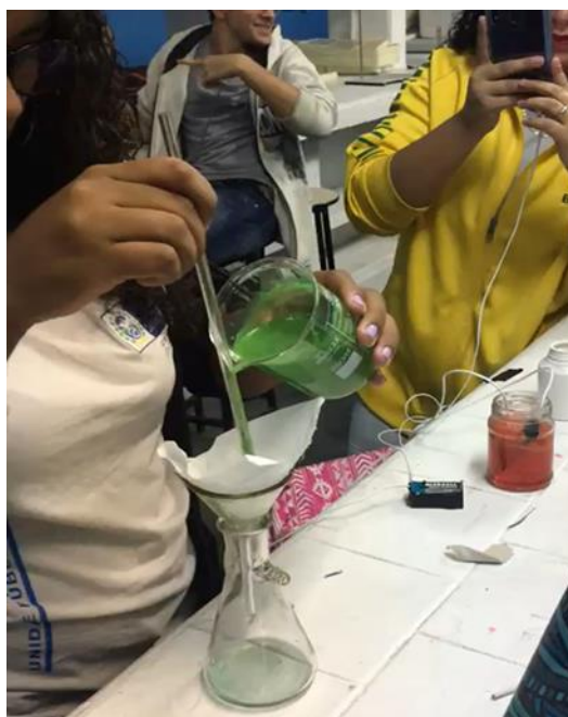
Figura 5: Aluna realizando a filtração após a eletrofoculação
