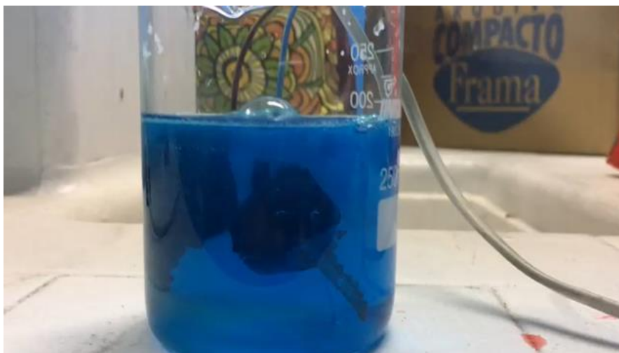
Figura 2: Sistema de eletrofoculação contendo o corante montado antes do processo
