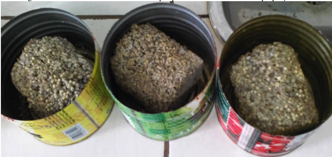
Figura 3: Amostras testadas em trabalho de pesquisa da camada drenante na proporção 1:5:5
