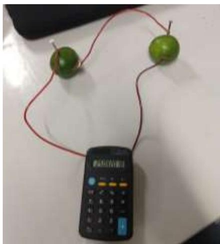
**Figura 02**–Experimento: Pilha com limões.
