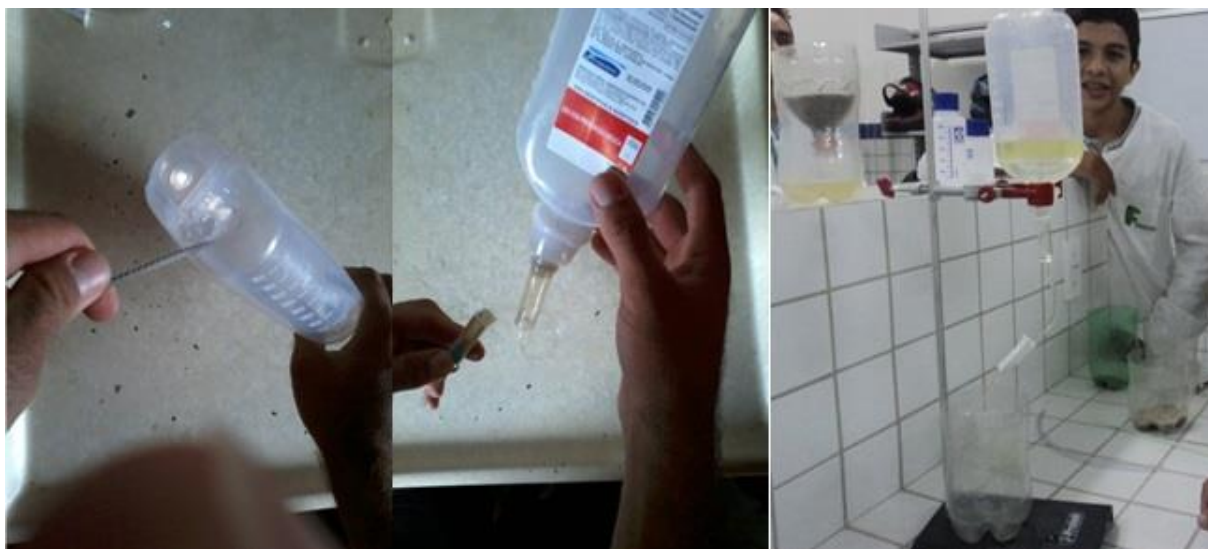
Figura 6: Perfuração do tubo de soro e respectivo encaixe e equipamentos finalizado em uso.
