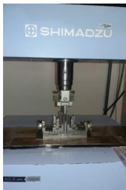
Figura 6. Ensaio de flexão sendo realizado na máquina de ensaios universal
