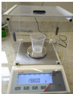
Figura 4: Pesagem da resina. Fonte: Arquivo pessoal do autor.
