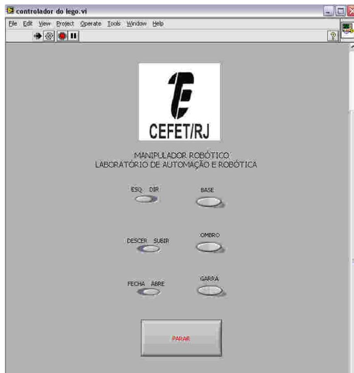
Figura 4. Tela do programa para controlar o robô desenvolvido em LabVIEW®.
