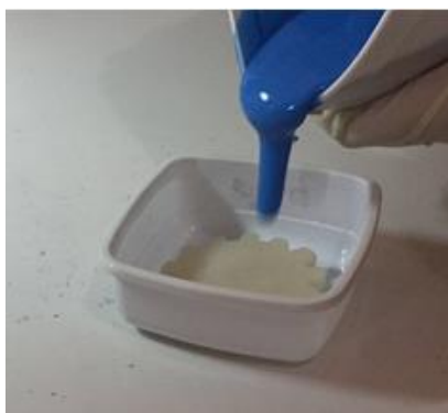
Figura 03: Molde de borracha sendo confeccionado
