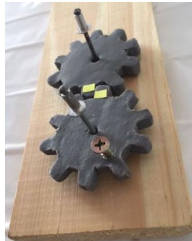
Figura 05: Kit para a demonstração de transmissão de movimento a partir dos dentes das engrenagens.
