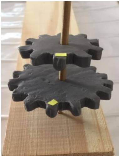
Figura 04: Kit para a demonstração de transmissão de movimento a partir de um eixo.
