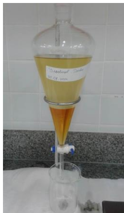
Figura 02 – Separação da glicerina e biodiesel
