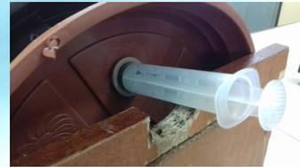
Figura 18: Seringa para o acionamento do freio.
