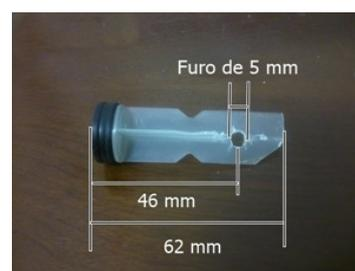
Figura 8: confecção do orifício de 5mm nas hastes das seringas.
