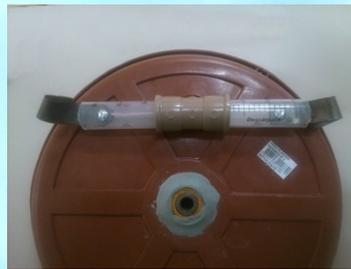
Figura 10: fixação das seringas na conexão em T no suporte das sapatas.
