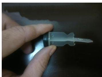
Figura 7: Corte das hastes das seringas.
