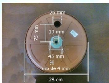
Figura 5: Montagem do suporte das sapatas do freio.
