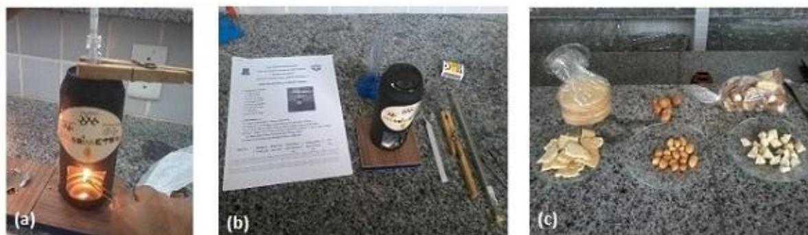
Figura 01: (a) Calorímetro artesanal reciclado; (b) kit experimental disponibilizado para o discente; (c) alimentos expostos a combustão (queima).
