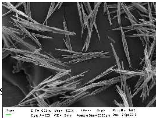
Figura 3. Forma de cristais do composto LPSF/GQ-238, constatada através da MEV.
