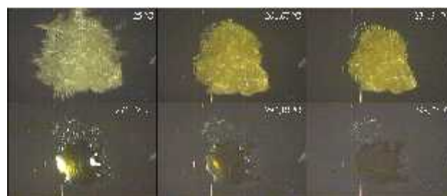
Figura 6. DSC fotovisual do LPSF/GQ 238 na razão de aquecimento de 2°C/min.
