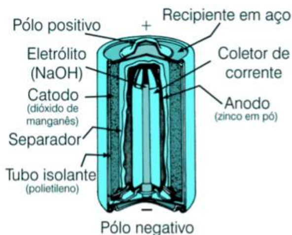
Figura 4. Pilha de zinco/dióxido de manganês (alcalina).
