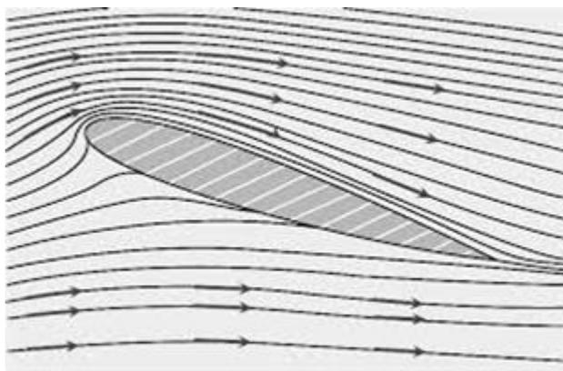
Figura 1: Escoamento de um fluido em um túnel de vento, e seus respectivos vetores velocidades.
