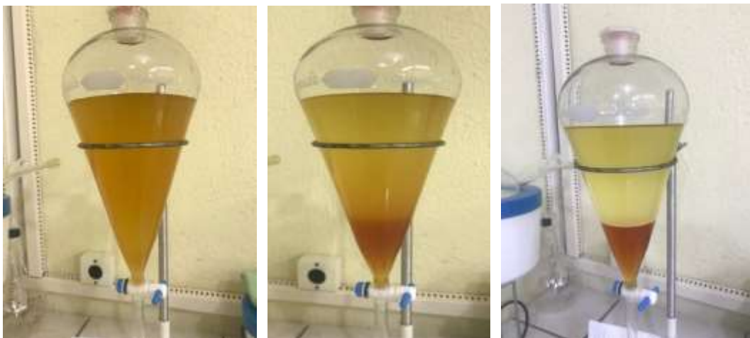
Figura 1. Processo de produção dos ésteres metílicos. (Fonte: Dados da Pesquisa, 2020)
