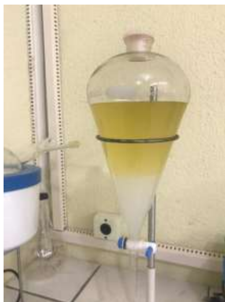
Figura 2. Processo de lavagem do biodiesel. (Fonte: Dados da Pesquisa, 2020)
