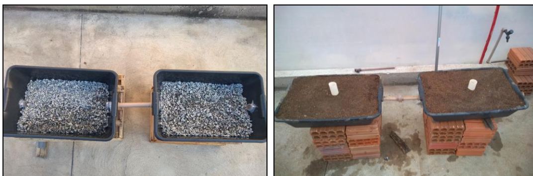
Figura 1. Construção do Sistema Constructed Wetland em escala de laboratório. Fonte: Autor (2020).
