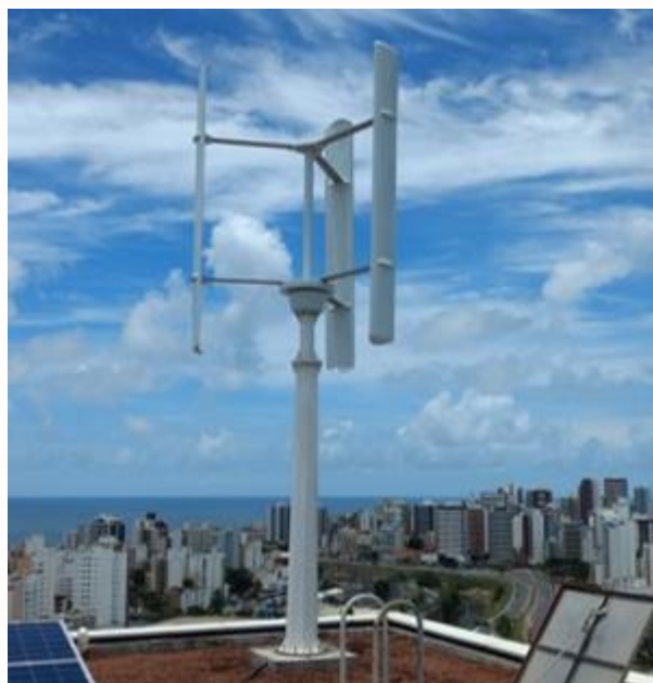
Figura 2: Aerogerador de eixo vertical do tipo H-Darrieus (RAZEC 266)
