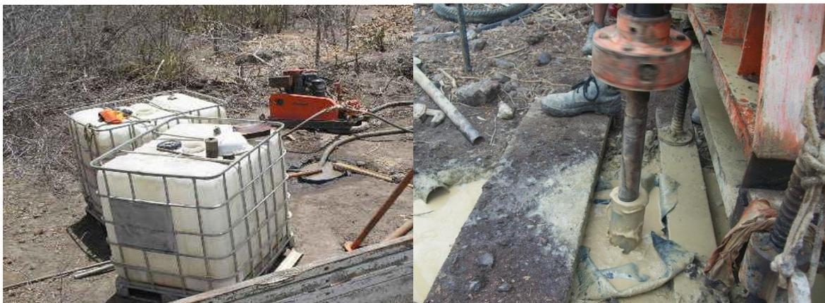
Figura 4 – Sistema de reaproveitamento de água.
